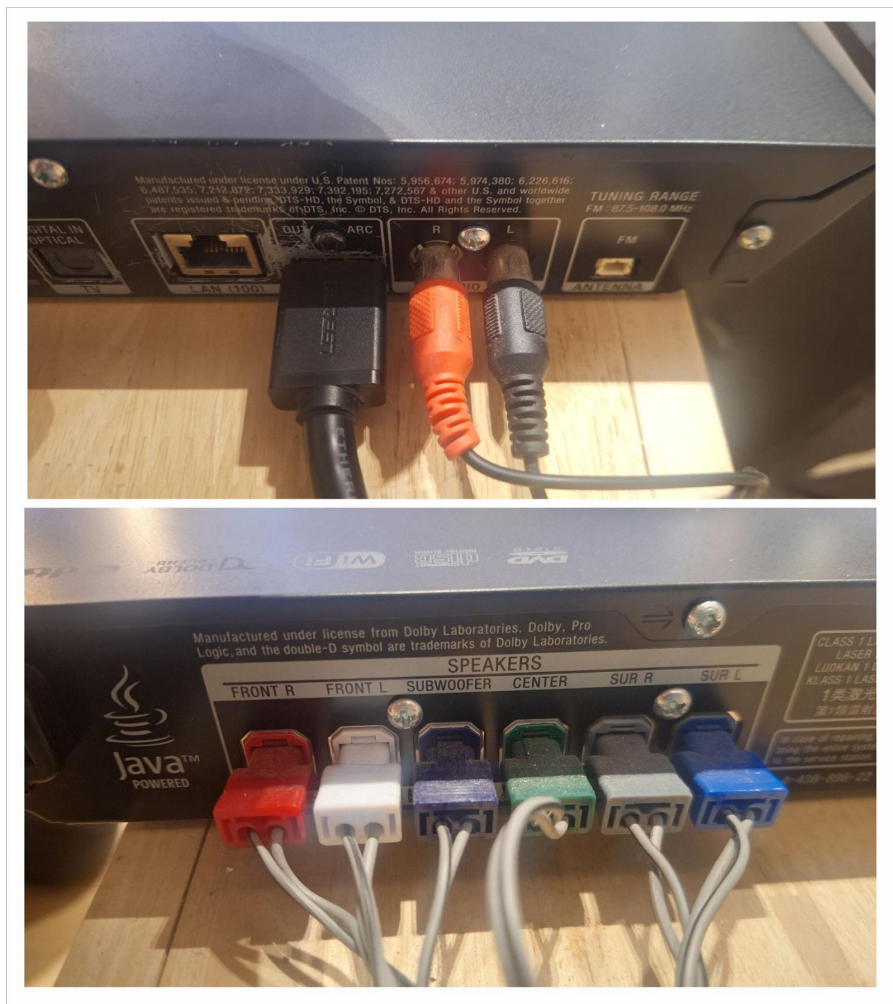
ภาพที่ 3.4 แสดงการเชื่อมต่อสาย HDMI และสายลำโพง ของเครื่องเล่น Blu-ray Disc
