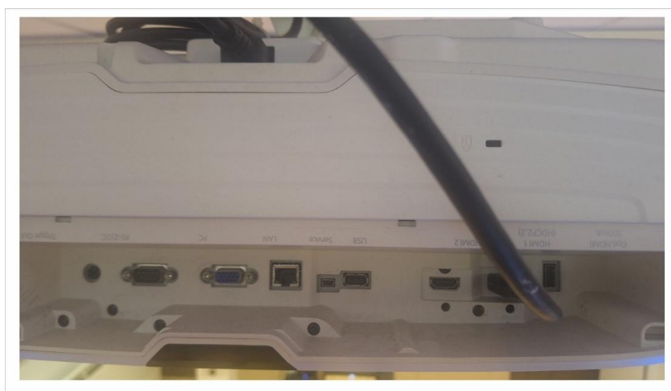
ภาพที่ 4.1 แสดงการตรวจสอบสายสัญญาณการเชื่อมต่อสาย HDMI และสายลำโพง
