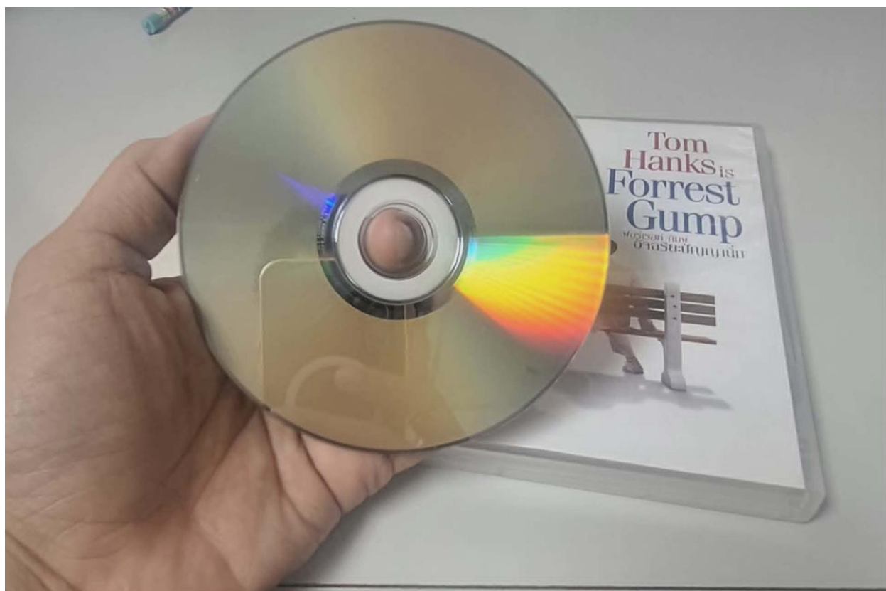
ภาพที่ 4.8 แสดงการส่องแผ่นกับแสงเพื่อหารอยขีดข่วนหรือคราบสกปรก
