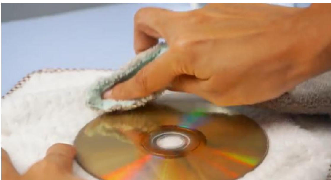
ภาพที่ 4.9 แสดงการขีดจากกลางแผ่นออกสู่ขอบแผ่น
