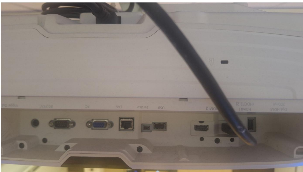
ภาพที่ 3.3 แสดงการเชื่อมต่อสาย HDMI กับเครื่องโปรเจคเตอร์
