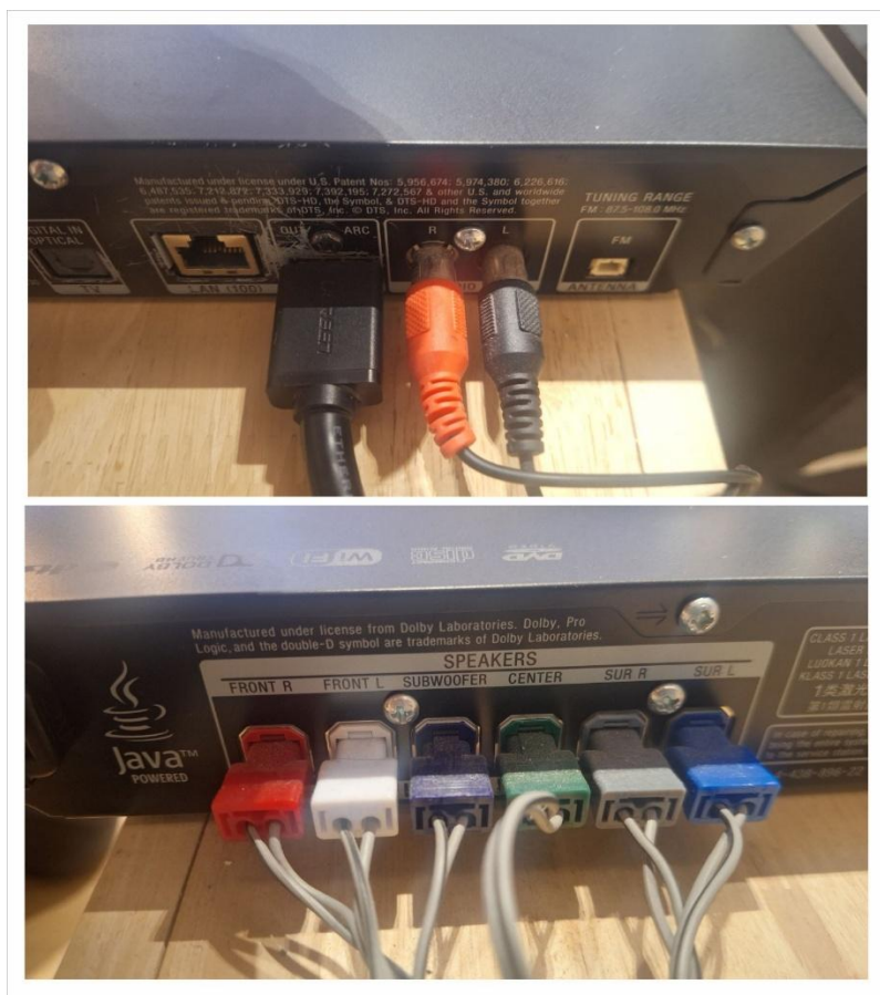
ภาพที่ 4.1 แสดงการตรวจสอบสายสัญญาณการเชื่อมต่อสาย HDMI และสายลำโพง
