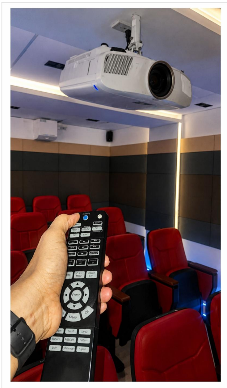
ภาพที่ 4.4 แสดงการกดปุ่ม Power ที่รีโมท และ แสดงไฟสถานะสีเขียว (Warm-up) บนตัวเครื่อง
