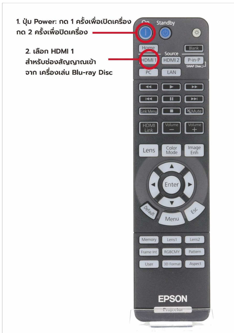
ภาพที่ 3.7 แสดงการเปิดเครื่องโปรเจกเตอร์ด้วยรีโมทคอนโทรล
