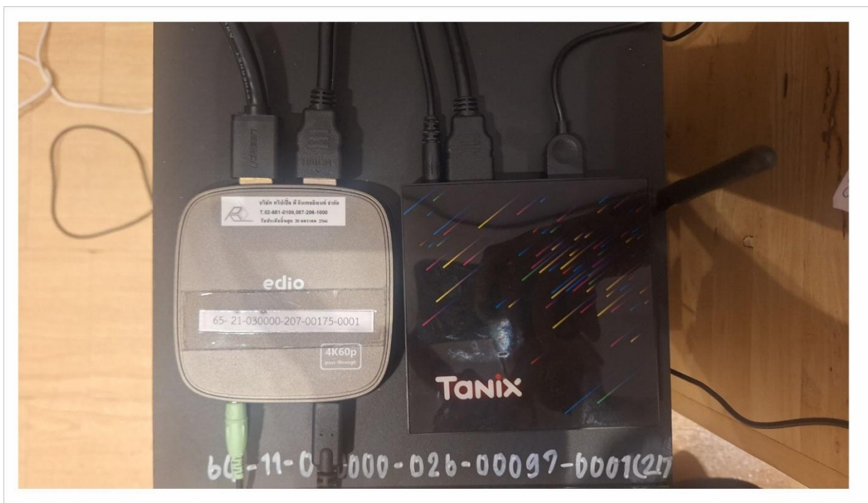
ภาพที่ 3.5 แสดงการเชื่อมต่อสาย HDMI กับอุปกรณ์สตรีมมิ่ง
