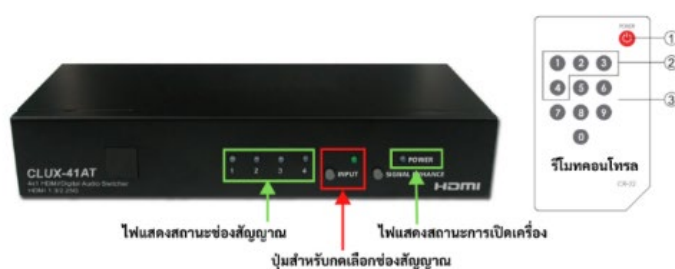
ภาพที่ 4.21 การใช้งานปุ่มสลับช่องสัญญาณภาพ HDMI บนอุปกรณ์สลับสัญญาณภาพ
