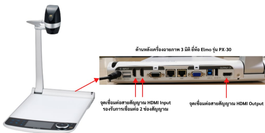
ภาพที่ 4.22 การเชื่อมต่อสายสัญญาณ HDMI Output บนเครื่องฉายภาพ 3 มิติ ยี่ห้อ Elmo รุ่น PX-30
