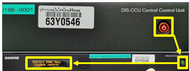
ภาพที่ 4.7 แสดงตัวอย่างการกดปุ่มเปิด ใช้งานเครื่องควบคุมไมโครโฟนการประชุม
