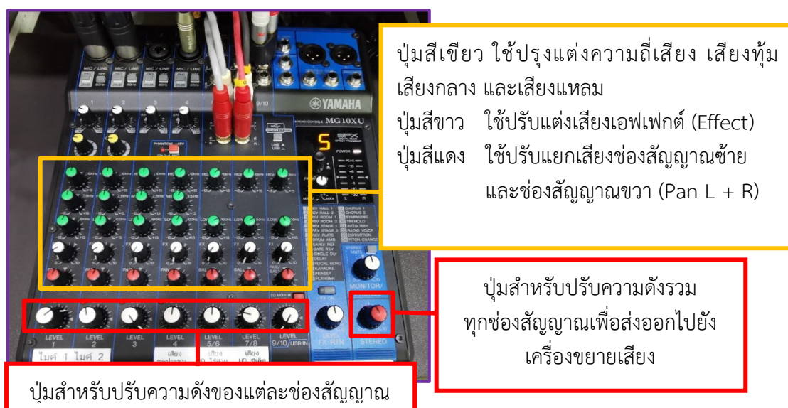
ภาพที่ 4.16 การใช้งานปุ่มต่าง ๆ ที่สำคัญบนเครื่องผสมสัญญาณเสียง (Mixer) YAMAHA รุ่น MG10XU
