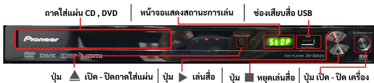
ภาพที่ 4.15 การใช้ปุ่มควบคุมบนเครื่องเล่น CD , DVD , USB ยี่ห้อ Pioneer รุ่น DV-3052V
