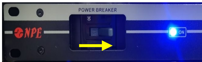
ภาพที่ 4.5 แสดงตัวอย่างการเปิดเซอร์กิตเบรกเกอร์ไปในตำแหน่ง ON
