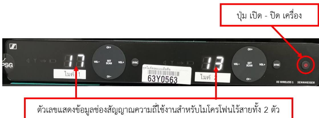
ภาพที่ 4.13 การเปิดใช้งานเครื่องรับสัญญาณไมโครโฟนแบบไร้สาย
