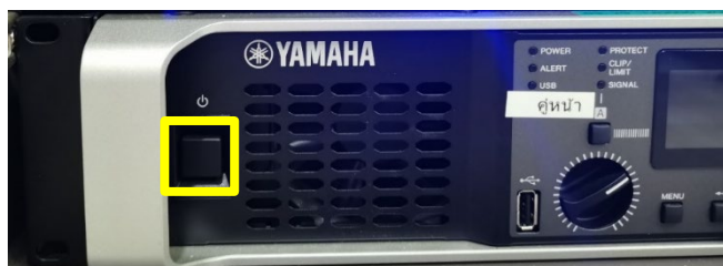
ภาพที่ 4.6 แสดงตำแหน่งปุ่ม เปิด – ปิด เครื่องขยายเสียง ยี่ห้อ YAMAHA รุ่น PX 3
