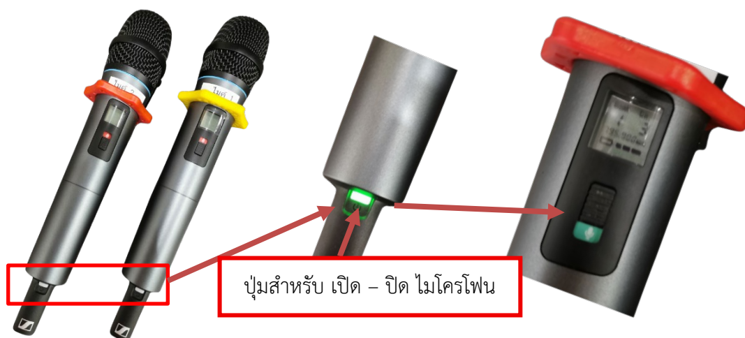
ภาพที่ 4.14 การเปิดใช้งานไมโครโฟนแบบไร้สาย
