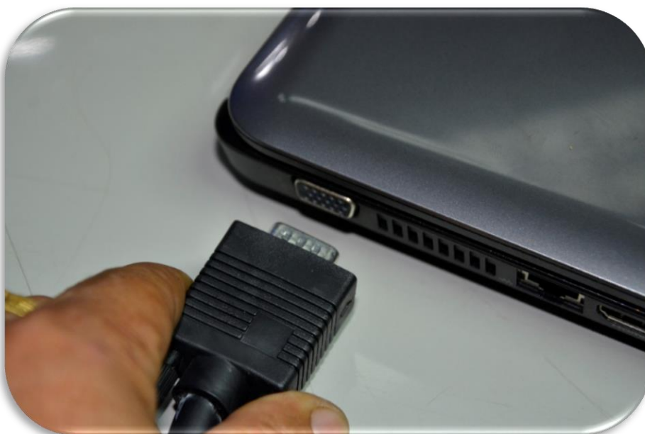
ภาพ 4.24 การต่อสายสัญญาณแบบ VGA ด้านข้างเครื่องคอมพิวเตอร์ไปยังเครื่องฉายภาพ Projector
