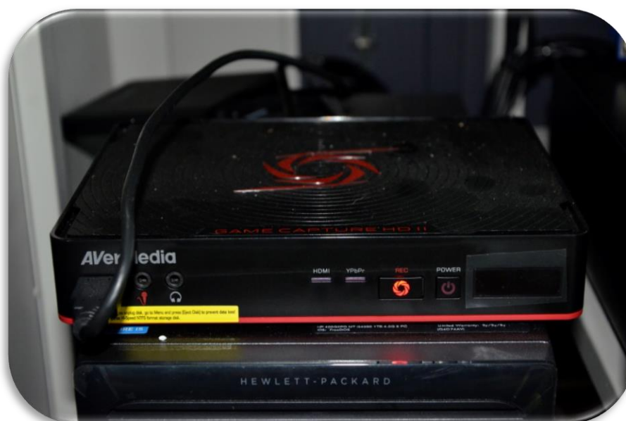
ภาพ 4.63 การกดปุ่มเครื่องบันทึกโดยการกดปุ่มเรคคอร์ด(Records)ที่รีโมทไฟสีแดงจะติด
