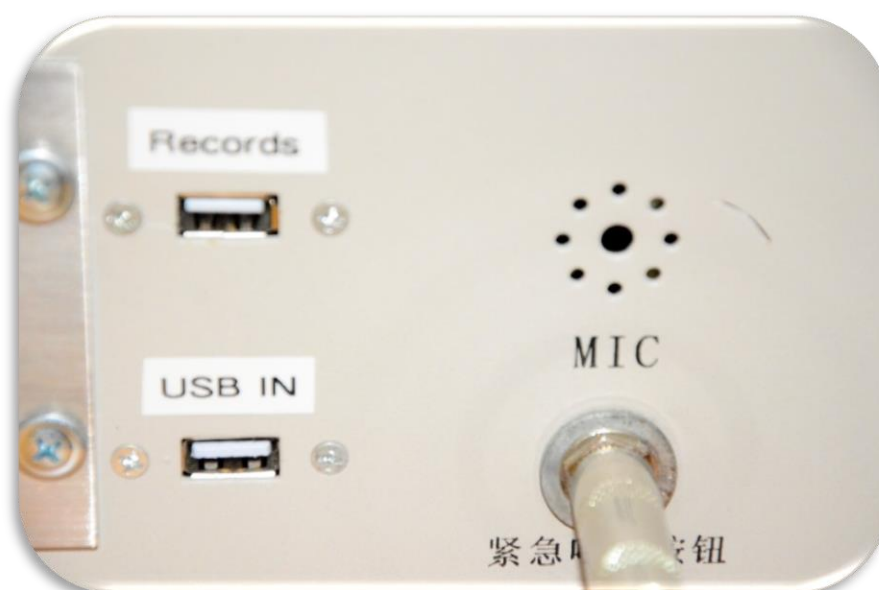
ภาพ 4.59 ภาพช่องเสียบพอร์ทต่อแฟลชไดรฟ์(flash-drive) เป็นช่อง USB IN
