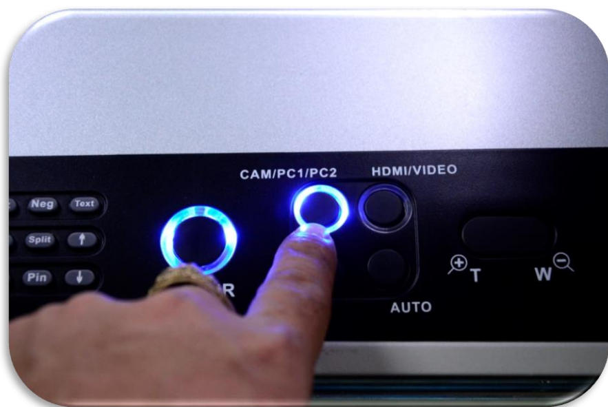
ภาพ 4.55 ภาพกดสวิตช์เลือกสัญญาณ In put ระหว่างเครื่องฉายภาพสามมิติกับคอมพิวเตอร์โน้ตบุ๊ก ไฟสีน้ำเงินติดสว่างจะเป็นเครื่องฉายภาพสามมิติ แต่ถ้าไฟสีเขียวติดสว่างจะเป็นสัญญาณจากเครื่องคอมพิวเตอร์โน้ตบุ๊ก
