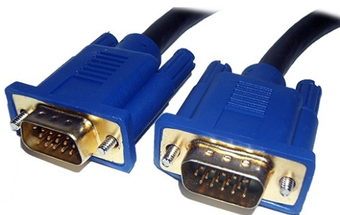
ภาพที่ 3.3 ลักษณะสายสัญญาณภาพ VGA
