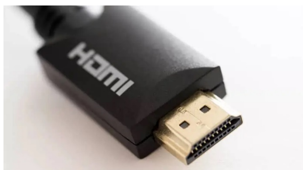
ภาพที่ 3.4 ลักษณะสายสัญญาณภาพ HDMI
